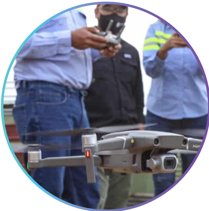
Utilización de drone para el tendido de líneas
